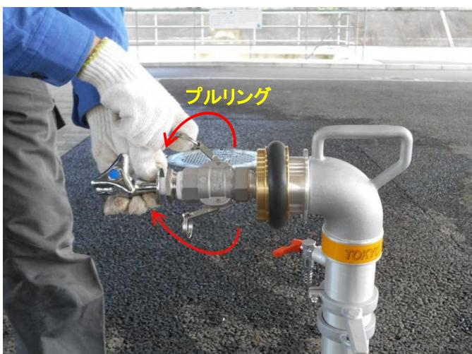
接続金具の挿し口に挿し込んだ状態で、蛇口アダプター受け口のプルリングを水平にするまで引いて、しっかりと固定します。
