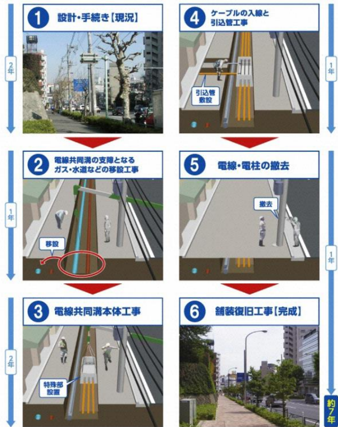
図-7 電線共同溝方式の工事手順
